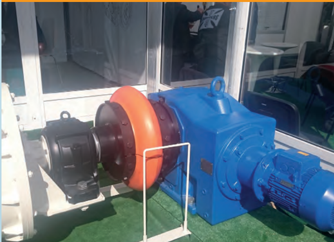
Radiální ventilátory BAB 120 TOP-M120 850kW/745 ot/min
