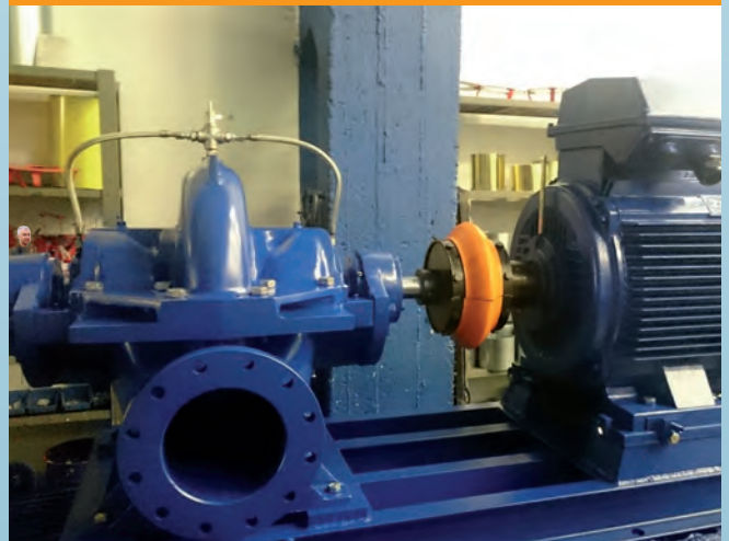
Pohonné systémy čerpadel TOP-M70 160kW/1485 ot/min
