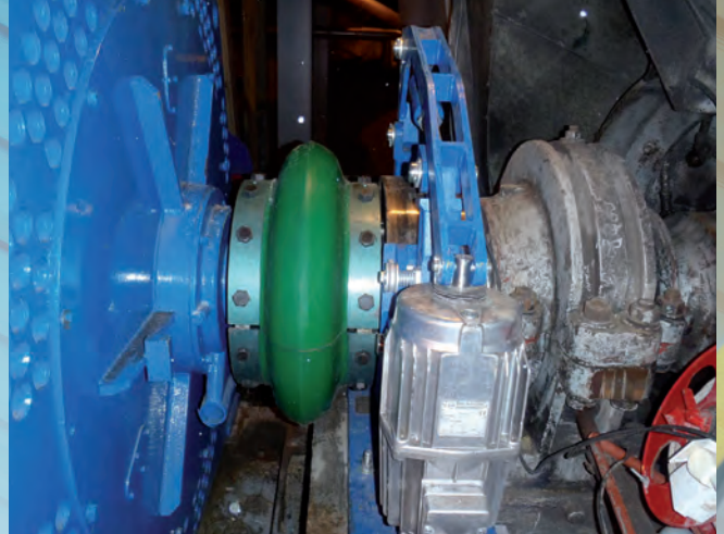
Kulové mlýny MKM 25 TOP-MB80/AMB 200kW/740 ot/min
