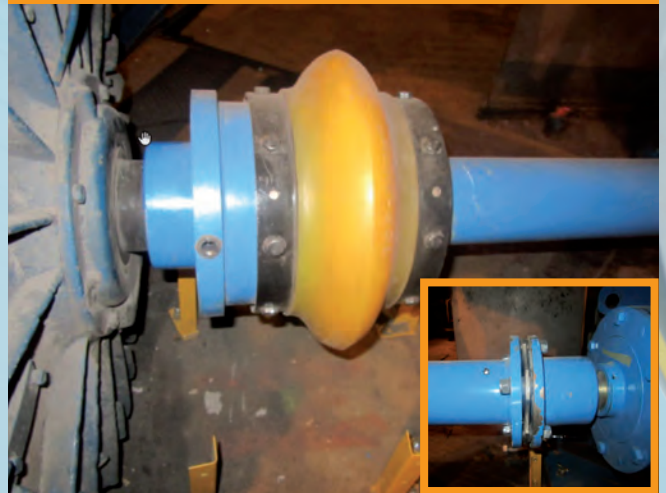
Pohonné systémy čerpadel TOP-M70 160kW/1485 ot/min
